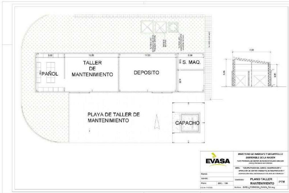
La cubierta y los cerramientos por encima del zócalo de mampostería de bloques será materializado por chapa T101 trapezoidal con aislación termina con de lana de vidrio de 50 mm con foil de poliéster blanco.
