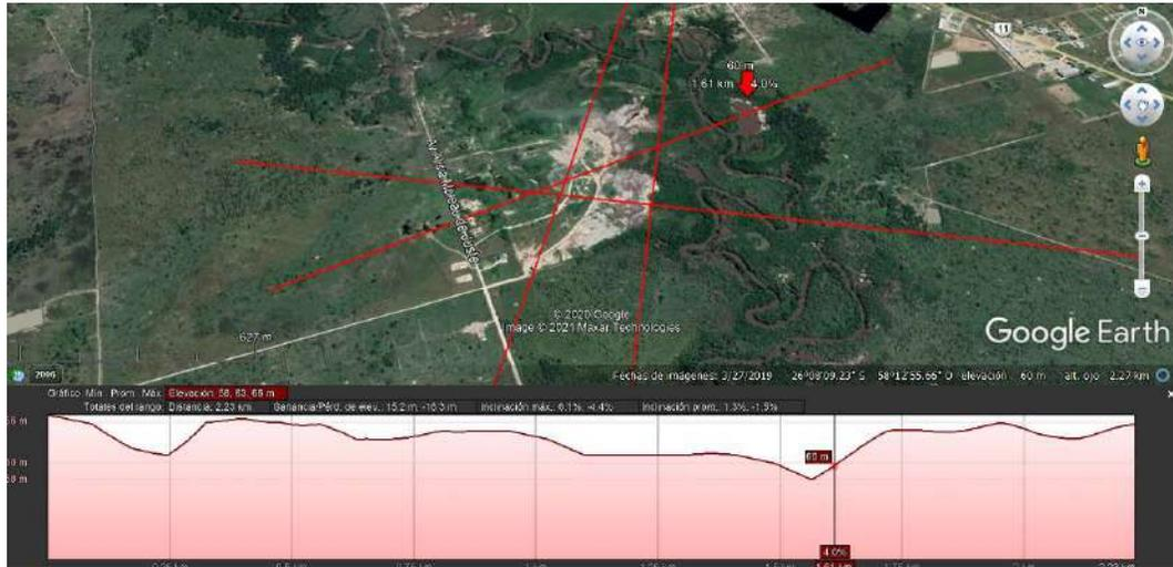
La figura ilustra un perfil topográfico realizado con la herramienta de Google Earth en una transecta en dirección aprox. O-E atravesando el predio del proyecto, que al igual que otros realizados en distintas direcciones en el sitio, arroja pendientes del orden de 1 a 1,5 % y máximas de aprox. 4 % en sectores próximos al cauce del riacho Formosa.
