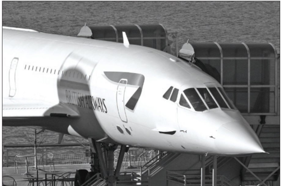
Concorde'n nokka taitui lähestymisen aikana 12,5 astetta. Kaikki kuvat: Miikka Hult
