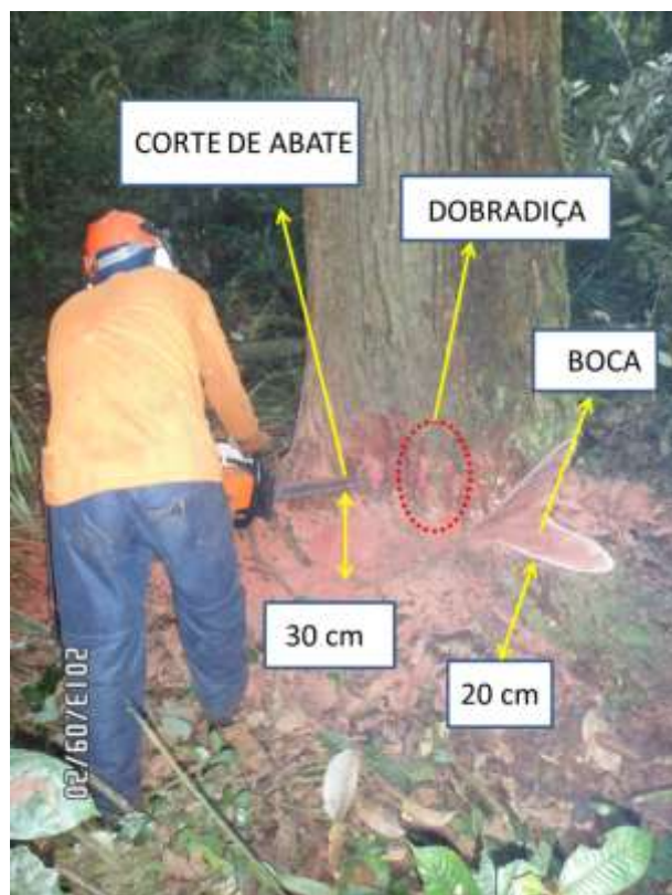
Figura 28 – Aplicação da técnica de corte direcional
