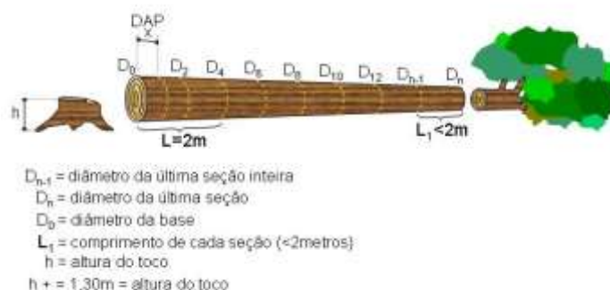
Figura 34 – Ilustração da medição das árvores segundo a metodologia de Smalian.
