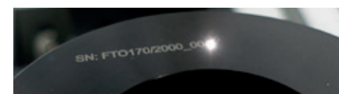
Abbildung 15: Gravieren von schwarz eloxiertem Aluminium
