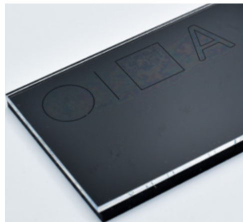
Abbildung 6: Mikrostrukturen beim Laserdurchstrahlschweißen
