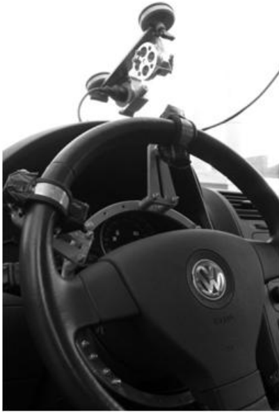
Abbildung 3.15: Montage des Lenkradwinkelsensors im Fahrzeug
