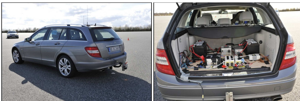
Bild 4.1 Verwendeter Versuchsträger mit Hinterradverstellung und Messtechnikaufbau
