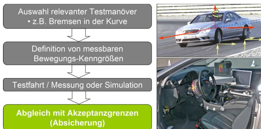
Bild 2.1 Methodik der Bewertung von Fahrsicherheit durch die Fahrzeughersteller (Schritte 1-3) und nicht standardisierte Absicherung (Schritt 4)
