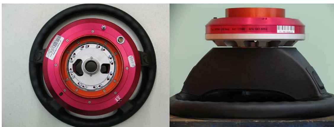
Bild 2.6 Messlenkrad zur Erfassung von Lenkradwinkel und Lenkradmoment, abgebildet bei Armbruster
