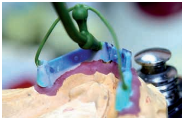
Figura 13.- Tenemos la barra modelada y preparada para colocar en revestimiento, utilizamos las últimas técnicas de colado para obtener un buen ajuste
