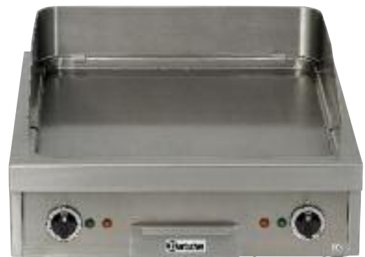
Elektro-Griddleplatte glatt B 600 x T 600 x H 200 mm Bratfläche 520 x 520 mm 2 Heizzonen Hartplattiert Edelstahl Anschlusswert: 3NAC 400V - 7.5 kW Gewicht: 62 kg Best.-Nr. 620.109 CHF 6'220.- / R 1
