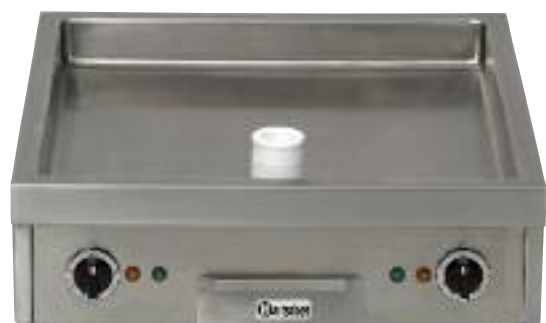
Elektro-Multibräter B 600 x T 600 x H 200 mm Tiegel 520 x 520 x 60 mm Hartplattiert Edelstahl, dicht verschweisst Ablaufloch mit Teflonstopfen und Ablaufschublade Anschlusswert: 3NAC 400V - 7.5 kW Gewicht: 62 kg Best.-Nr. 620.460 CHF 6'890.- / R 1
