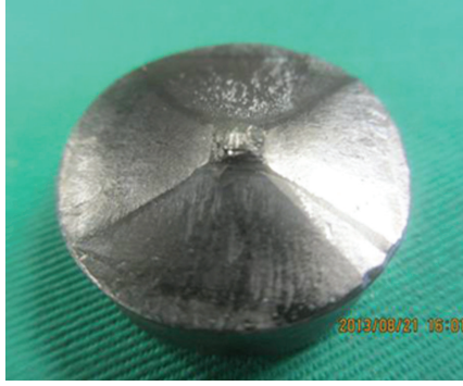
Şekil 10. IG yöntemiyle üretilen REBCO örneğinin üstten görünümü [43].
