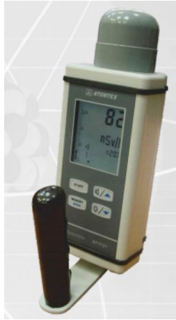
Şekil 2. Atomtex AT1121 sintilasyon gama dedektörü
