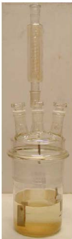
Abbildung 37.4.2: AUSLAGERUNGSGEFÄSS MIT RÜCKFLUSSKÜHLER
