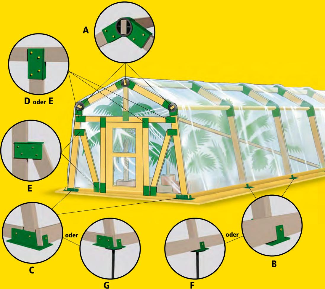
**Hinweis:** Die Verbinder „D“ + „E“ sind fast identisch. Der Unterschied ist eine offene Seite mehr beim Verbinder „E“. Der Vorteil dabei ist: Es können auch diagonale Verbindungen realisiert werden. Der Nachteil ist: Der Verbinder ist deshalb nicht ganz so stabil und für Rahmen Verbindungen insbesondere für die Herstellung von Türen und Fenster nicht ganz so gut geeignet.
