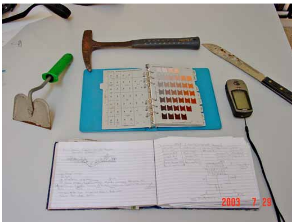
Figura 2-6. Instrumentos de campo más empleados: martillo para rocas, palín y cuchillo para limpieza de perfiles, carta de colores Munsell, receptor de sistema de posicionamiento global (GPS) y cuaderno de campo
