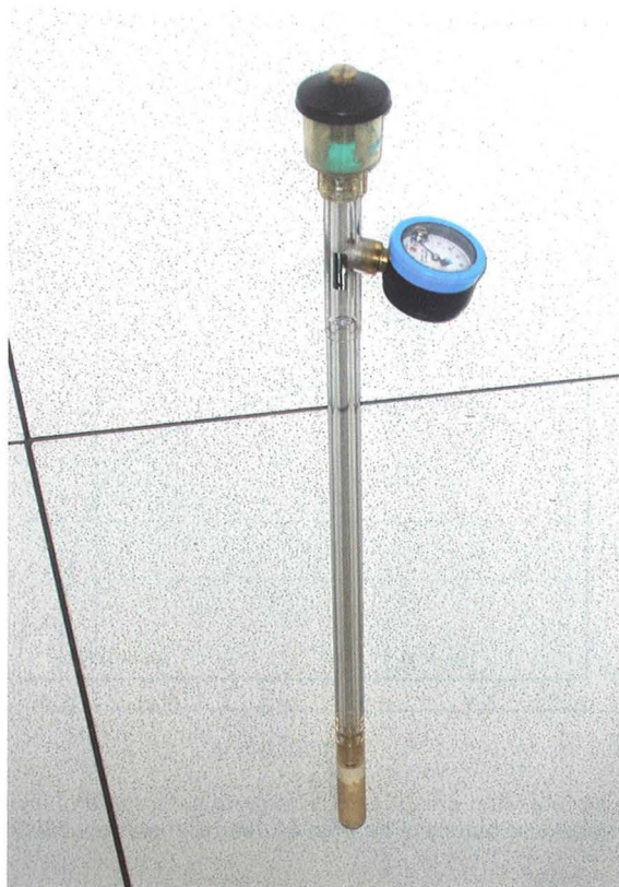
Foto 2.9. Los tensiómetros, en sus diversas variantes, son instrumentos muy utilizados para la caracterización in situ del estado hídrico de la zona no saturada. Miden el potencial total del agua (potencial matricial y potencial gravitacional respecto a la superficie del terreno) a la profundidad a la que se sitúa la cápsula porosa.
