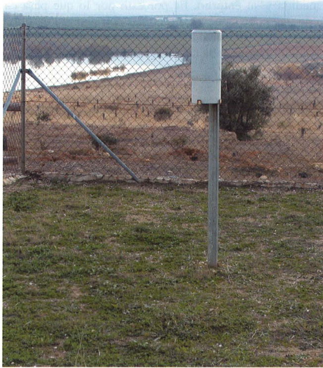
Foto 1.7. Los pluviómetros en su forma más simple (pluviómetros no registradores), consisten en un receptáculo de forma cilíndrica que finaliza en un embudo por el que el agua llega a un depósito diseñado para reducir la evaporación. Foto: Estación meteorológica del Centro de Visitantes de la Laguna de Fuente de Piedra (Málaga), 2004.
