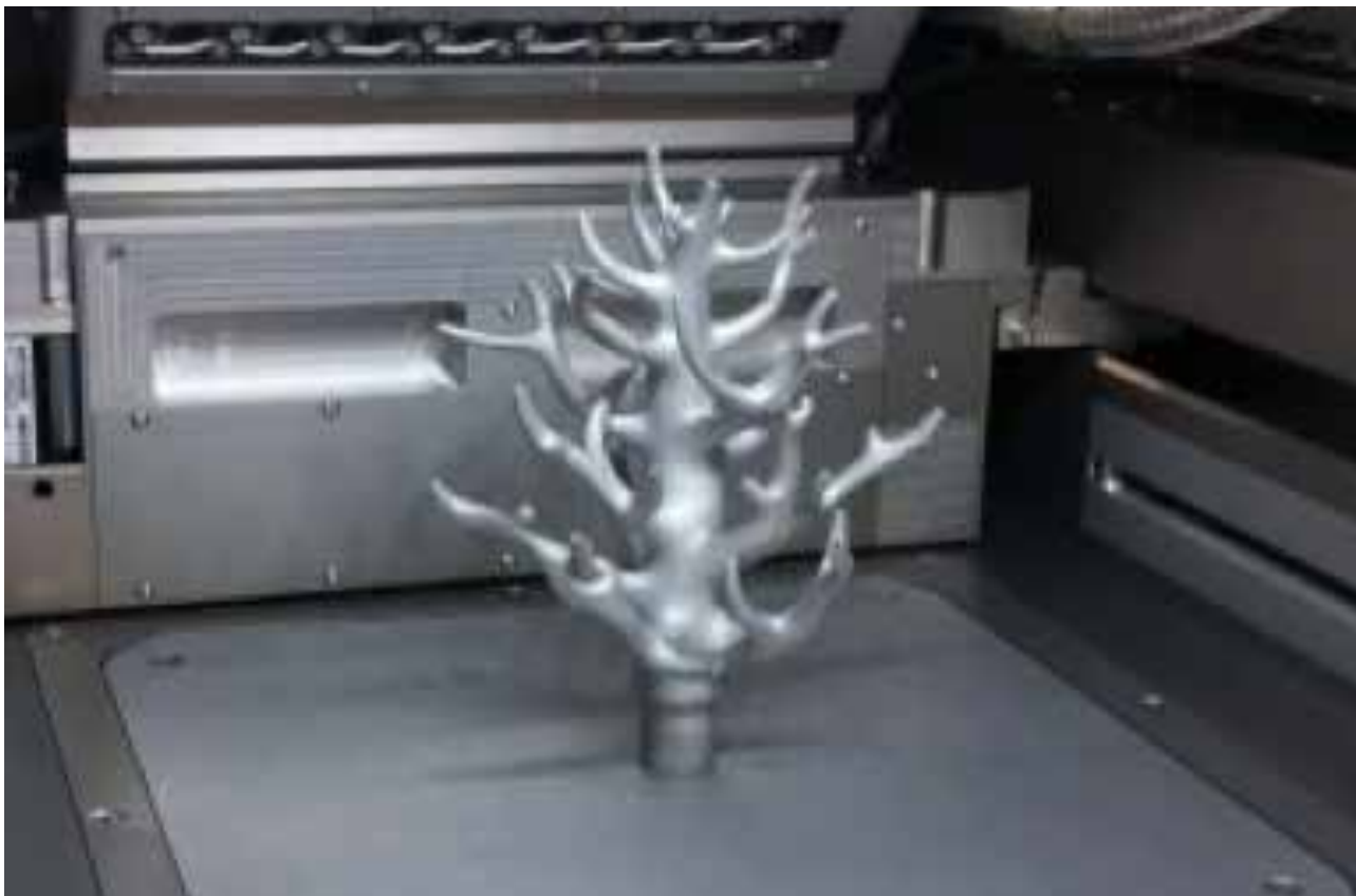
Fabrikazio gehigarria, laser bidezko fusio selektiboko teknologia erabiliz (SLM / powder bed additive manufacturing). Amaitutako pieza konplexua, fabrikazio-ganbaran (IK4-LORTEK).
