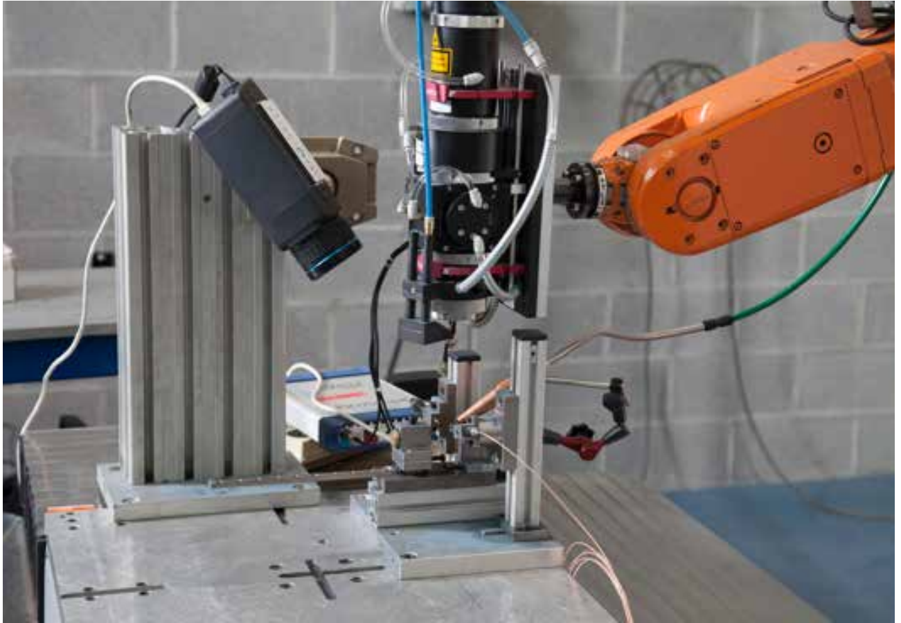
Laser bidezko soldadura-prozesua (buru optikoa), prozesua monitorizatzeko sistemarekin eta kamera termografikoarekin (IK4-LORTEK).
