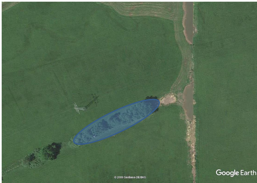
Abb. 98: Das geplante Feuchtbiotop hat eine Länge von 100 m, ist ca. 10 m bis 12 m breit und max. 1 m tief.
