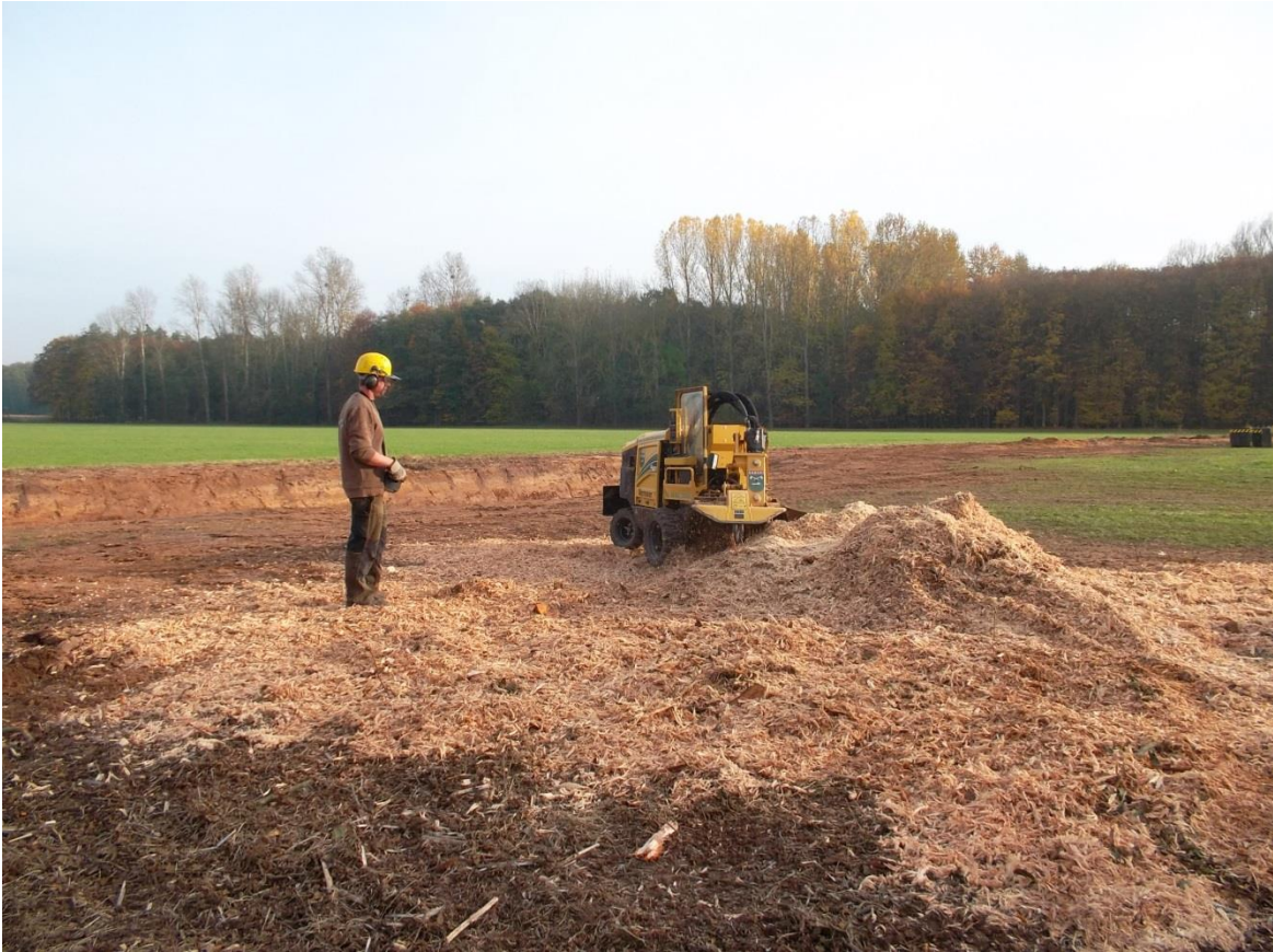
Abb. 55: Die Baumstumpffräse funktioniert über eine Fernbedienung. © GNA
