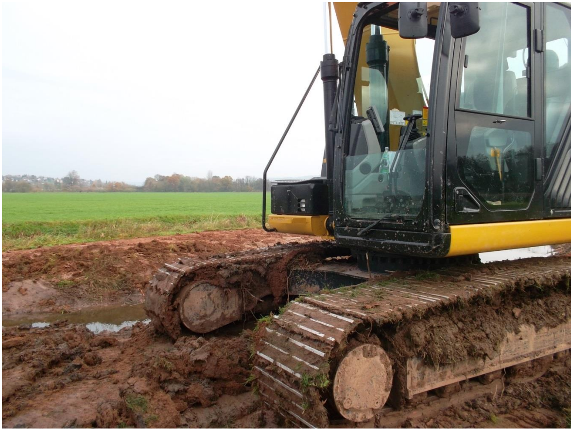
Abb. 79: Der Boden ist auch am 15.11.2017 nur bedingt geeignet. Deshalb kommt ein Langarmbagger mit 80 cm Kettenbreite (anstatt 60 cm) zum Einsatz. Die Arbeiten schreiten zügig voran. © GNA
