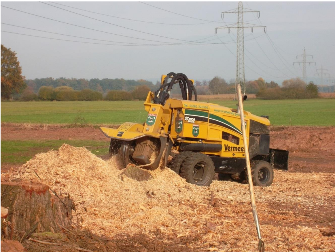
Abb. 54: Abschließend kam eine Baumstumpffräse zum Einsatz, um Stockausschläge zu vermeiden. © GNA
