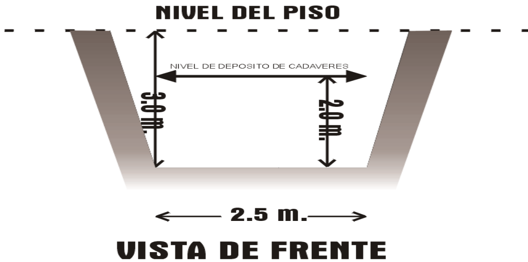
Zanja tipo trinchera.
