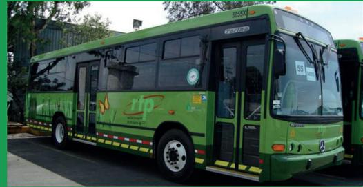
Figura 3: Autobús de RTP que utiliza gas LP como combustible.
