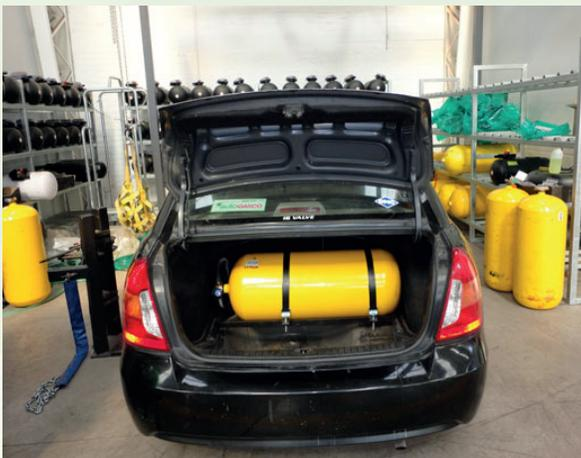
Figura 1: Tanque para Gas LP en vehículo particular.
