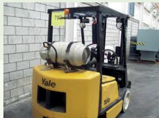
Figura 4: Montacargas modificado para usar Gas LP.
