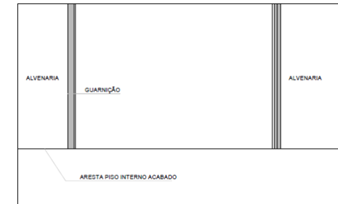
11. COLOCAÇÃO DA GUARNIÇÃO INTERNA (VISTA INTERNA)
