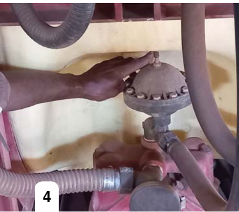
4 Kubalulekile ukukhangela iindawo ezivuzayo emibhojeni nakwizifakelelo logama sisebenza isitshizi naxa iivalvu zivaliwe.
