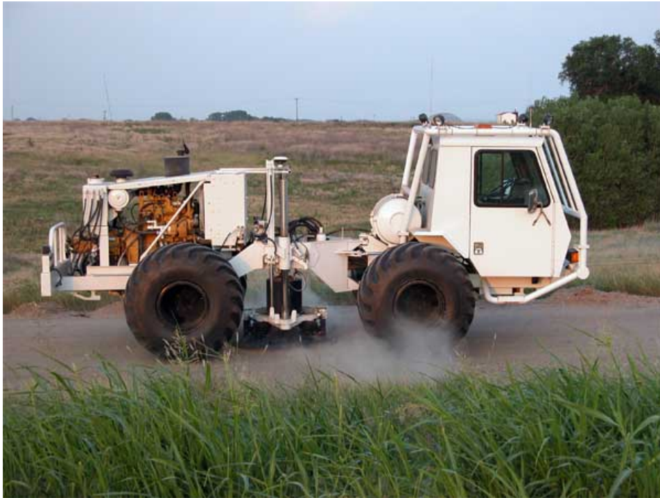
Εικόνα 1. Τυπικό όχημα για την παραγωγή δονήσεων σε σεισμικές διασκοπήσεις εν ώρα λειτουργίας. Διακρίνεται στο μέσο του οχήματος η ειδική πλάκα και τα υδραυλικά σύστημα για τη μηχανική παραγωγή δονήσεων (πηγή: http://www.kgs.ku.edu/Geophysics/4Dseismic/Reports/July_2005/index.html )
