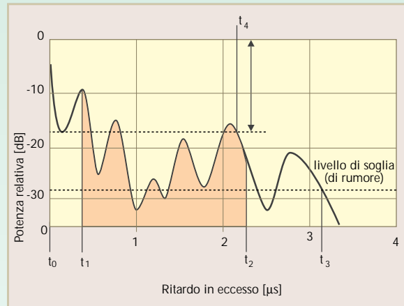
Esempio di Risposta Impulsiva con definizione dei parametri utilizzati nelle valutazioni statistiche.
