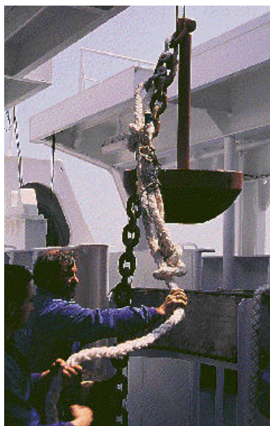
Posa a mare di un "grappino" per il recupero di un cavo.
