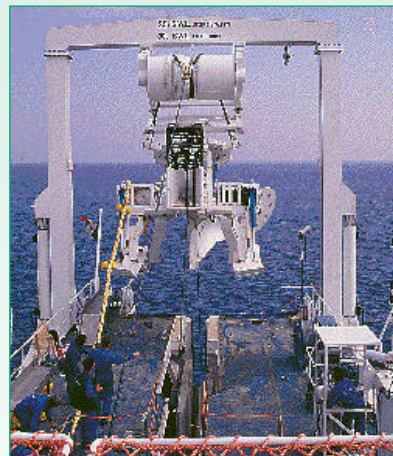
L'aratro impiegato sulla Teliri per interrare un cavo sul fondo del mare.
