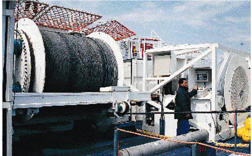
Sistema di guida dell'aratro sul ponte della Teliri. In primo piano il cavo per i comandi dell'aratro. Sotto, l'albero maestro della Teliri.
