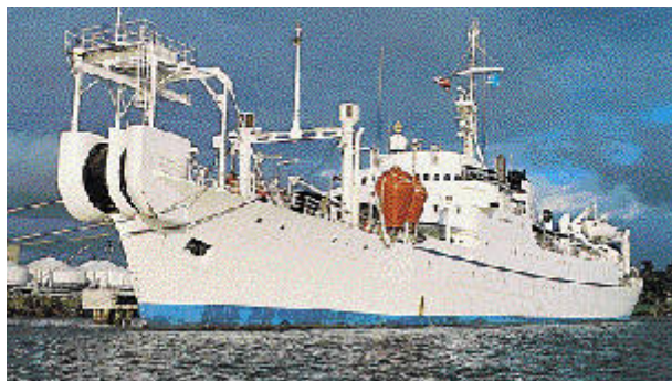
La nave Salernum: posò cavi per i gestori di TLC italiani dal 1954 al 1985.
