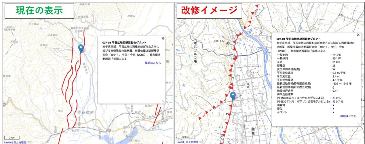
第2図 活断層 DB が目指す位置情報提供のイメージ 現状(左図)では、活断層線の位置精度は1/20万地形図レベル。これを右図の1/5万レベルに引き上げていく。また、どのような活断層なのか(地下での傾斜方向など)も表示できるようにする。基図は地理院地図。
