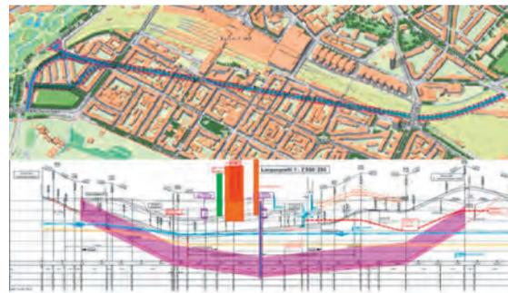
Dieses Längenprofil verdeutlicht, wie weit hinab - maximal 20 Meter - unter dem Geleisefeld der Strassentunnel geführt wird.
