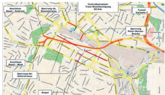
Hier werden die Streckenführung des geplanten Tunnels und die vorgesehenen flanierenden Massnahmen dargestellt.
