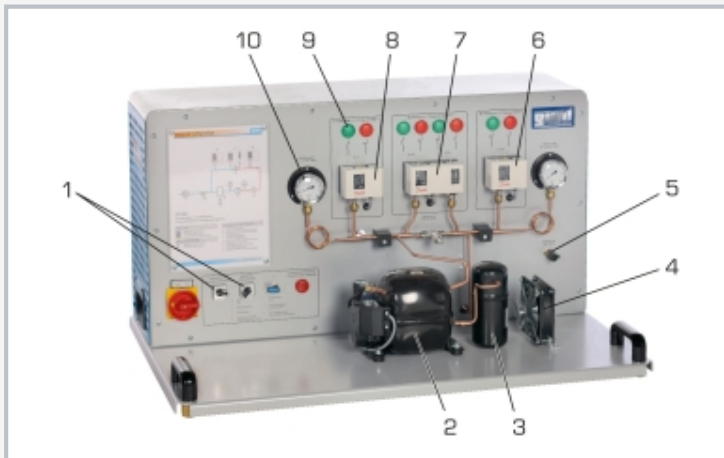
1 Bedienelemente, 2 Verdichter, 3 Sammler, 4 Gebläse, 5 Entlüftungsventil, 6 Hochdruck-Druckschalter, 7 Kombi-Druckschalter, 8 Niederdruck-Druckschalter, 9 Signallampen für Schaltzustand, 10 Manometer
