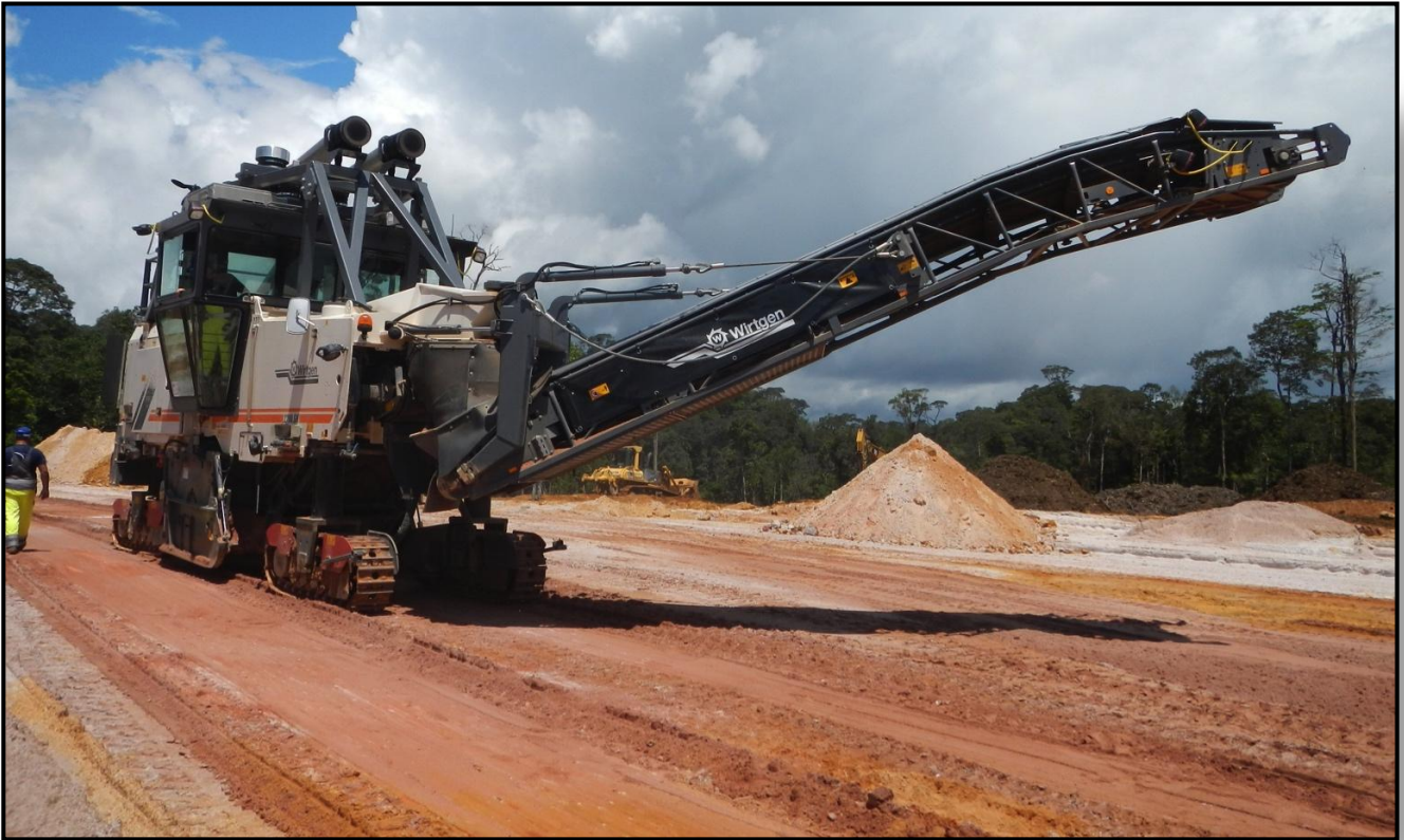
Figure 8 : Surface Miner et son fonctionnement
