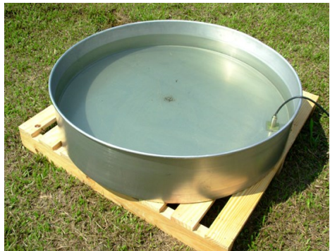
Figura 4.15. Tanque de evaporación
