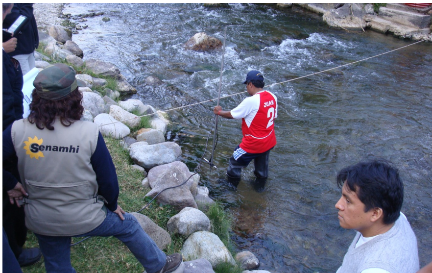
Figura 4.26. Batimetría y aforo con molinete. Fuente: Adaptado por Ordoñez, 2011.
