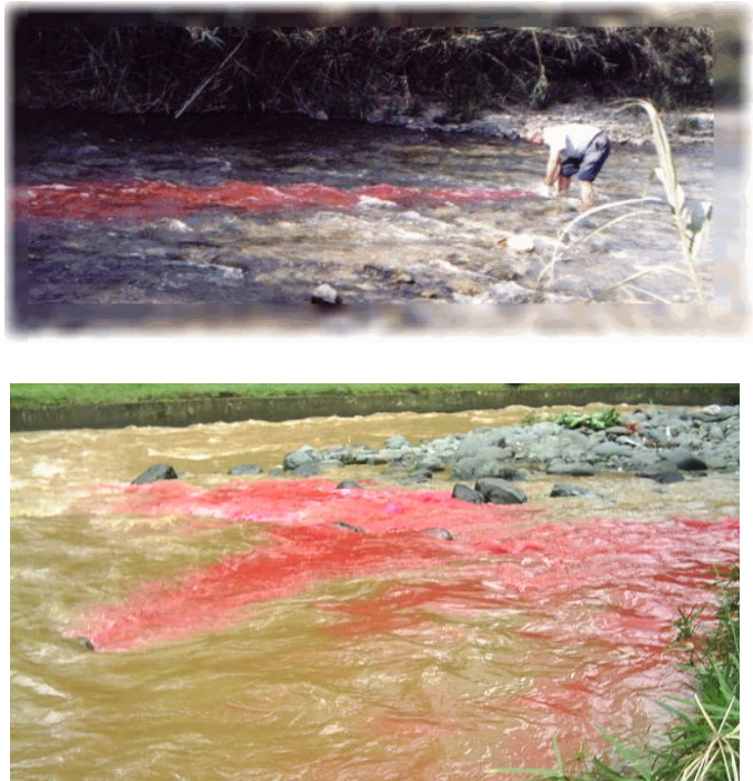
Figura 4.28. Aforo con trazadores químicos
