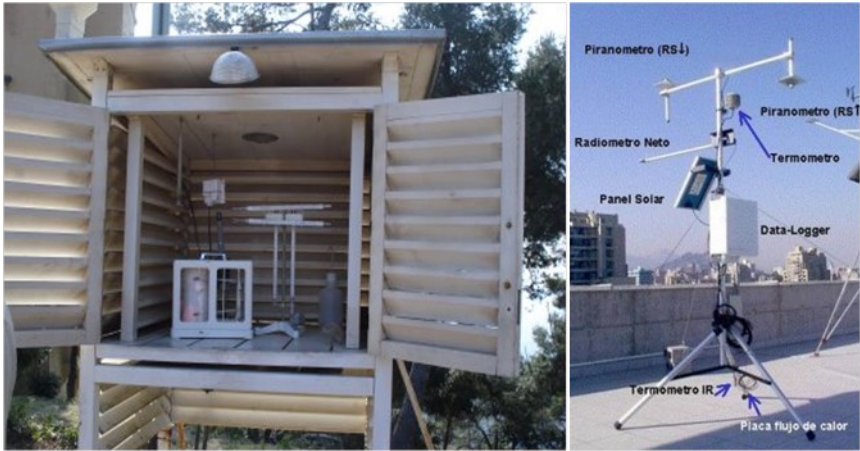
Figura 4.14. Estación convencional y automática Fuente: geohistoriatader.blogspot.com
