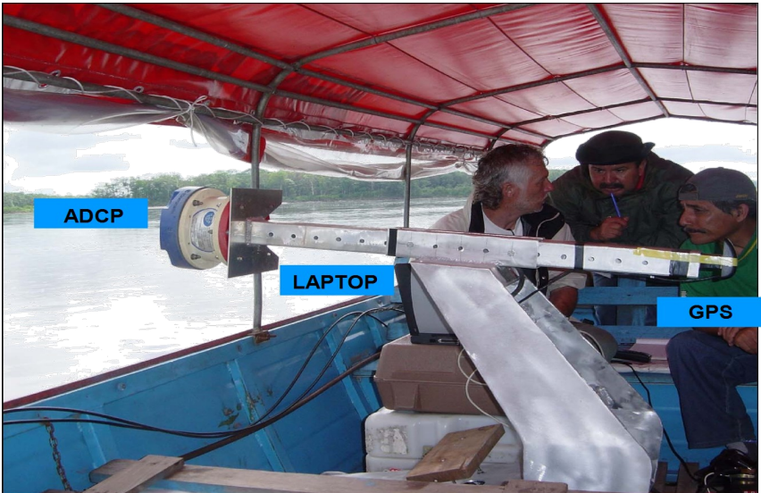
Figura 4.27. Aforo con ADCP. Fuente: Adaptado por Ordoñez, 2011.
