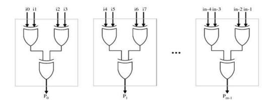
Figure 3.6. XOR parameter n-bit block extraction [5].
