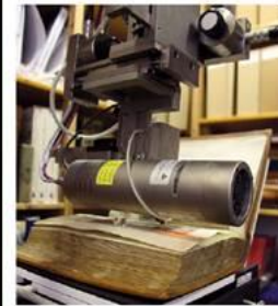
Abb. 16 – Anordnung der Geräte für XRF-Analyse des Breslauer Psalters. Ill. 16 – Setup used for XRF analysis of the Breslau Psalter.
