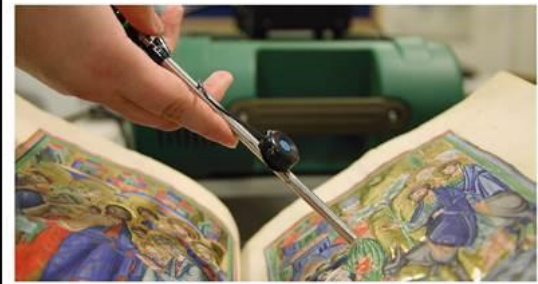
Abb. 15 – Anordnung des Geräts für FORS-Analyse des Breslauer Psalters. Ill. 15 – Setup used for FORS analysis of the Breslau Psalter.
