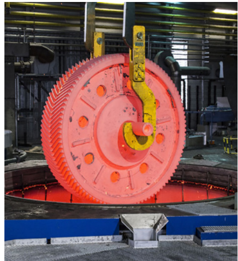
Bild 13: Vertikale Entnahme eines geschweißten Zahnrad zur Härtung
