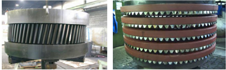
Bild 11: Horizontale Chargierung; links: Zahnrad mit Stützplatten, rechts: Kegelräder mit Stützplatten
