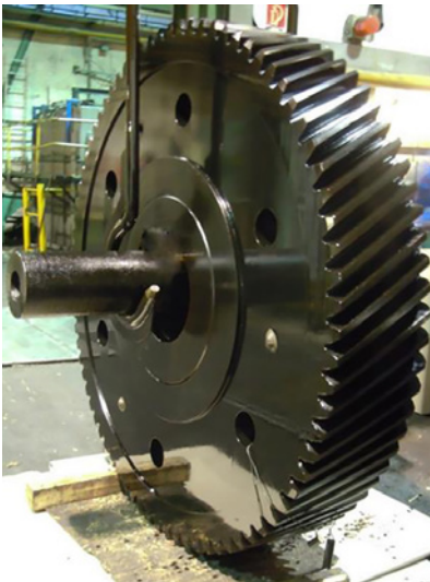
Bild 12: Vertikale Chargierung eines Schmiederads mit Nabenstützplatten
