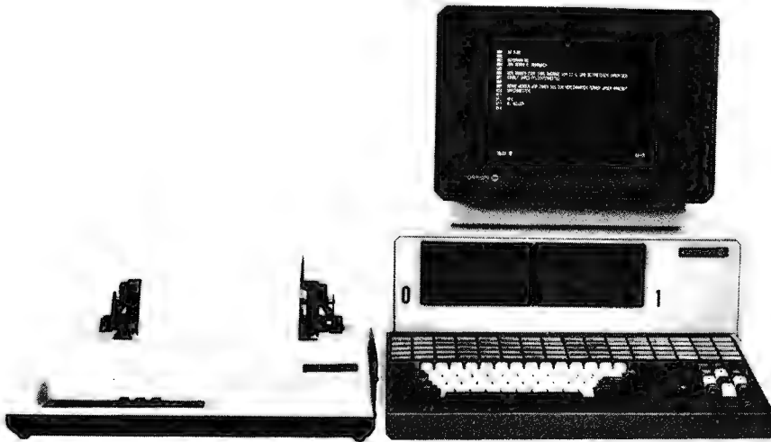
Das neue Telex-Verarbeitungssystem TVS-800 speichert Texte und sendet diese auf Tastendruck oder automatisch zur gewünschten Zeit aus.
