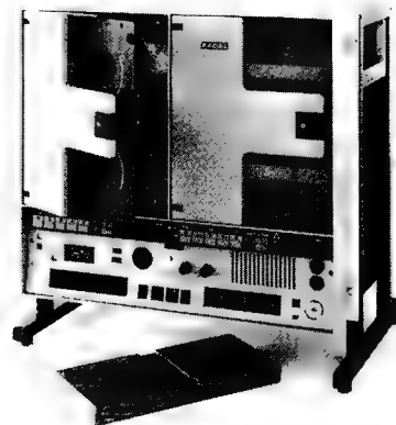
Das neue Mehrkanal-Tonbandgerät Autostore kann maximal 8 Kanäle gleichzeitig kontinuierlich über 24 Stunden aufzeichnen. Das Gerät wiegt rund 30 kg.
