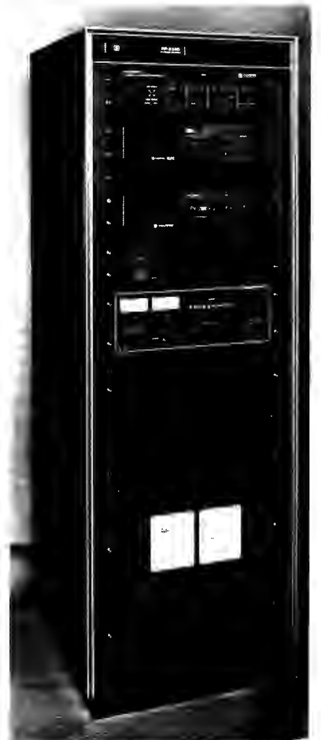
Bild 8: Beispiel einer kompakten Schiffsfunkstation für ARQ-Betrieb. Im Gegensatz zur beschriebenen Hauptstation wird hier nur 1 Sende/Empfangsantenne mit einem schnellen Antennenumschalter verwendet.
