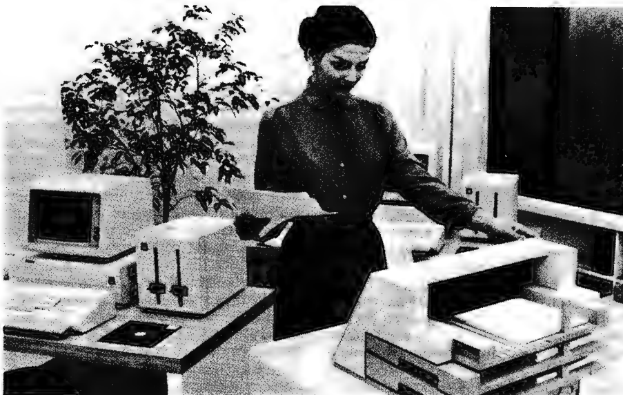
IBM-Schreib-System mit Korrekturhilfeprogramm für bis zu 50 000 Wörter. Links Arbeitsplatz mit reflexarmem Bildschirm und beweglicher Tastatur, Disketteneinheit mit zwei Laufwerken, elektronische Steuer- und Speichereinheit (unter dem Bildschirm), rechts der IBM-Typenradruker mit Einzelblattzuführung.
