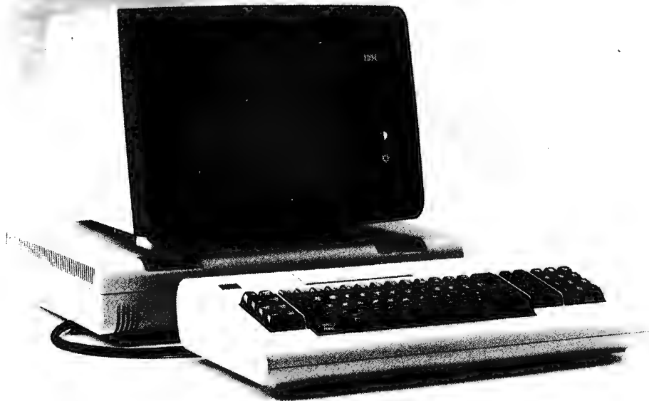
Die neue Bildschirmereinheit IBM 3101 ist benutzerfreundlich konstruiert und eignet sich für breit gestreute Datenkommunikation.
