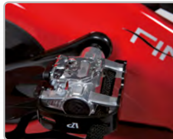
Pedale für Radschuhe (SPD-Click-System) oder normale Schuhe.
