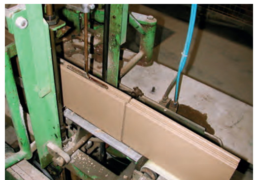
Die Platten werden auf Maß abgelängt
