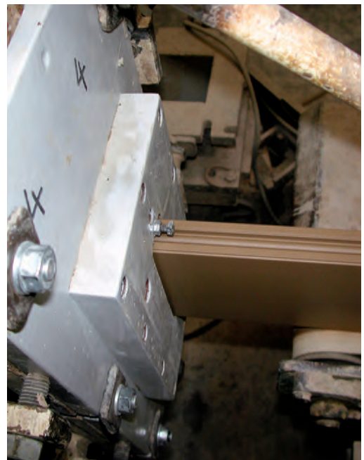
Der Ton wird durch das formende Mundstück gepresst
