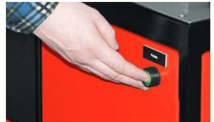
Steuertaste für das Schneidgerät.
