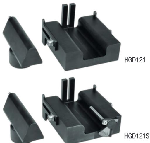
Zum Biegen von Stromschienen. Biegewinkel : 0° - 90°.
