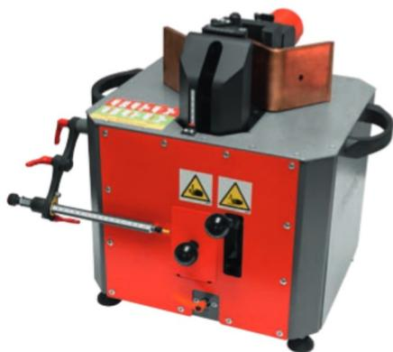
Der Bearbeitungswagen zum Schneiden, U- und Z-Biegen, Lochen von Al- und Cu-Stromschienen und zum Einpressen von Muttern:
