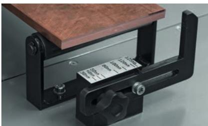
Zusätzlicher Anschlag zum vertikalen Schneiden.
