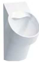
H840284 Absaug-Urinal ‚rimless‘, Wasserzulauf innen, ohne Löcher für Deckelmontage, mit elektronischer Steuerung, Batteriebetrieb (9V), Bluetooth, vandalensicher
