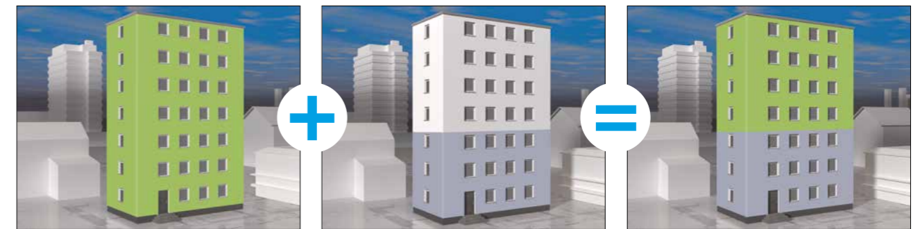
SCHUTZZONE RAUMBRAND + SCHUTZZONE SOCKEL = SCHUTZZONE FASSADE
