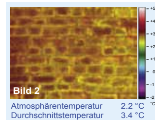
Bild 4 Die Klinker-Fassade wurde mit Isophob- F hydrophobiert.
