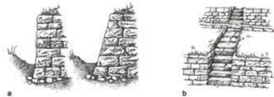
Abb. 3.29: Der Anlauf einer Trockenmauer bremst die Geschwindigkeit des herabfließenden Wassers (a), Gräben am Fuß der Mauern fangen das Oberflächenwasser auf und leiten es den Treppen zu (b)
