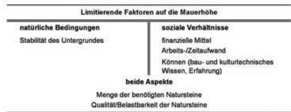
Abb. 5.2: Faktoren, die einen Einfluss auf die Höhe von Trockenmauern haben
