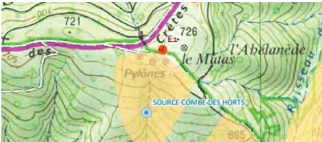
Carte 1 : POSITIONNEMENT DE L'EOLIENNE N°1 PAR RAPPORT AU PERIMETRE DE PROTECTION RAPPROCHE DE LA SOURCE COMBE DES HORTS
