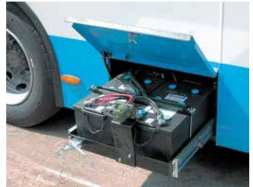
Für einen einfachen und schnellen Zugang zu diesen Batterieträgern sind Teleskopschienen des Typs 0522 montiert. Der Schientyp ist äußerst robust und durch Entlastungsbolzen vor Vibrationen und Stößen geschützt. Die spezielle Schienengeometrie vermeidet starke Verschmutzung.
