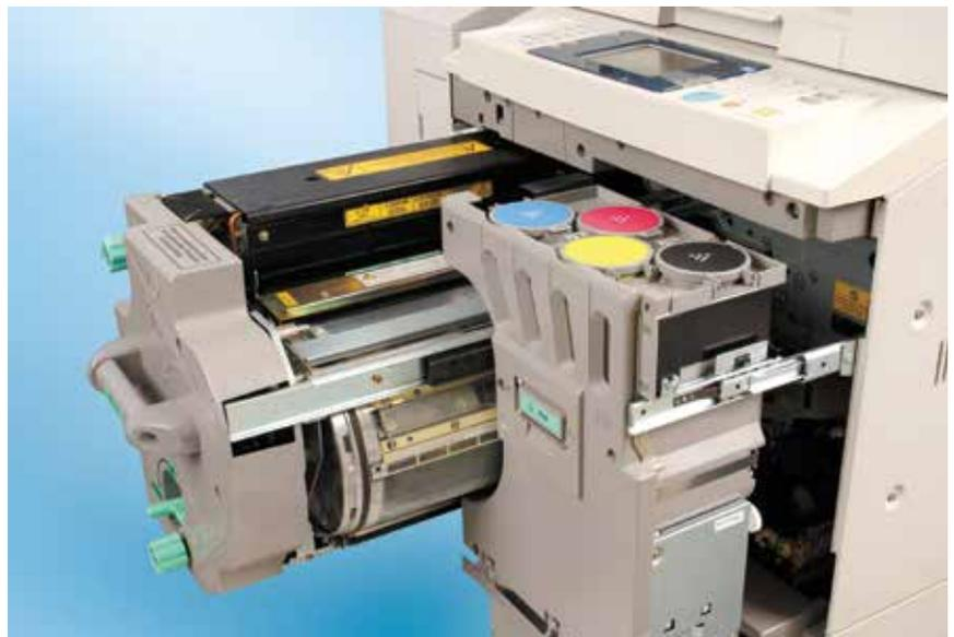
Teleskopschienen des Typs 7957 in einem digitalen Drucker. Das Innenteil kann nach einfacher Entriegelung herausgenommen werden. Durch Anwendung dieser Teleskopschiene kann bei Wartung und Montage viel Zeit eingespart werden.
