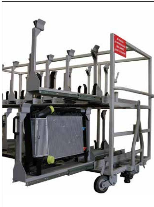
Teleskopschienen des Typs 5321 sind mit einer Auszugslänge von 300 bis zu 1100 mm und einer max. Belastung von bis zu 180 kg pro Paar erhältlich. Dadurch sind sie für eine große Bandbreite von Anwendungen geeignet.
