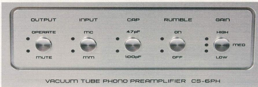
Das Rumpel-Filter setzt nicht zu früh ein und ist deshalb kein Klangverhinderer. Mit dem Gain-Schalter lässt sich der MC-Verstärkungsfaktor 57 und 65 dB dreistufig einstellen.
