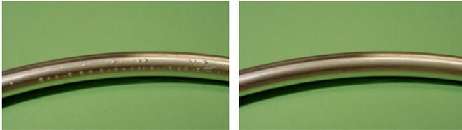
**Abbildung 1:** Blister (Blasen) auf einer Dichtung mit Standard-Silberbeschichtung nach 1000 Stunden Luftkontakt bei 260 °C (500 °F)
