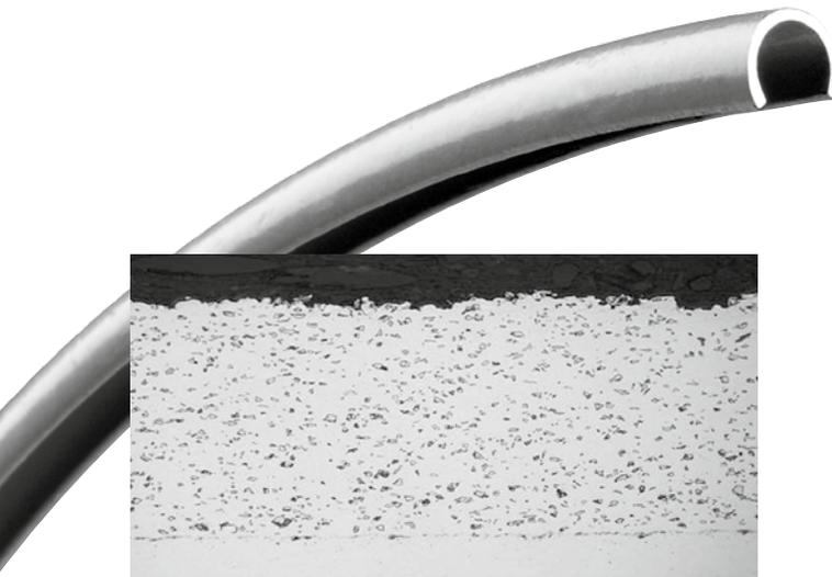
Abbildung 1: TriCom® ist eine Verbundbeschichtung, die aus einer Kobaltmatrix und einer Verstärkungsphase aus Chromkarbid besteht.
