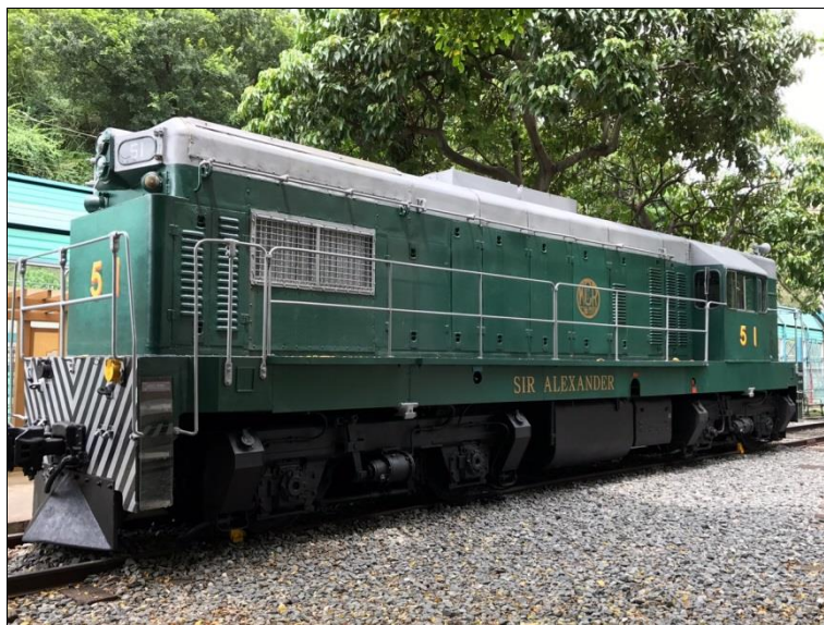
圖 3 在 1983 年鐵路電氣化前，九廣鐵路為公眾提供列車服務所用的 51 號柴油電動機車（現於香港鐵路博物館內）
