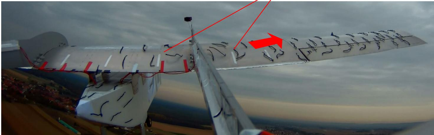
Nous constatons une progression du décrochage de l'axe de l'avion vers les extrémités, ce qui est propre aux ailes rectangulaires. Un tel décrochage est progressif et prévenant. Ceci est un facteur de sécurité quant au comportement de l'avion en début de décrochage : le contrôle en roulis est préservé (cf. cours sur la portance).
