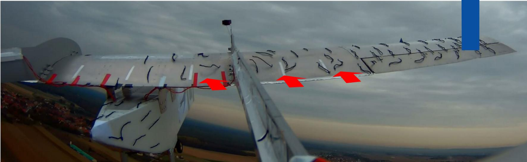
Le type de décrochage, décrochage de bord de fuite ou de bord d'attaque, dépend du profil (cf. cours sur la portance).
