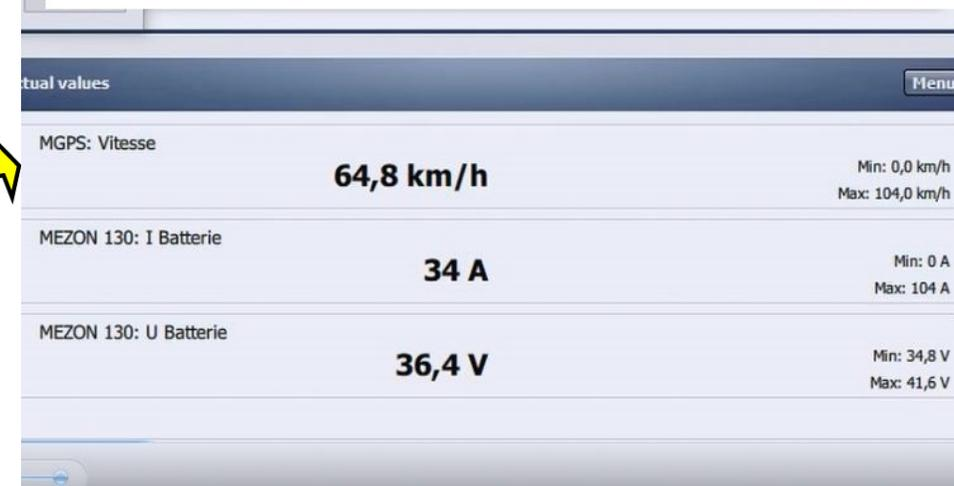
Nous constatons que la puissance à la vitesse de max est de 1200 W pour une puissance prévue de 650 W. Cette différence peut avoir plusieurs causes :
