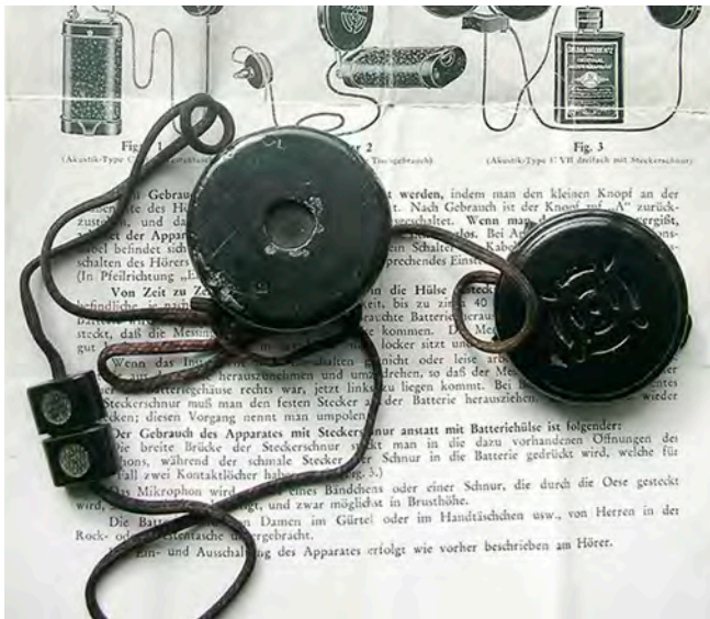
Abb. 98 Frühe elektrische Hörhilfen mit Kohlemikrofon.
