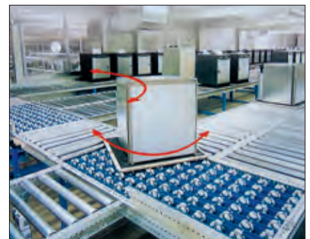
Auch Schwergut kann auf der Allseitenröllchenbahn schnell und problemlos die Richtung wechseln
