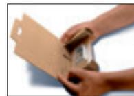
Seitenteile einklappen und in die Decklasche einwickeln
