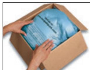
Einen zweiten Beutel aktivieren und oben auf das Produkt legen. Die Kartonklappen schließen, so dass der Schaum sich zu einem Oberpolster ausdehnt.
