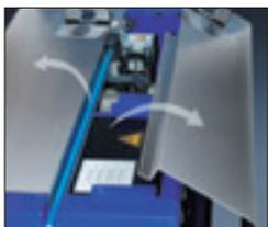
Die Arbeitsplatte kann für Wartungsarbeiten zu beiden Seiten geöffnet werden
