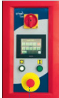
Touchscreen für einfache Bedienung und schnelle Einstellung der gewünschten Wickelungen, passwortgeschützt
