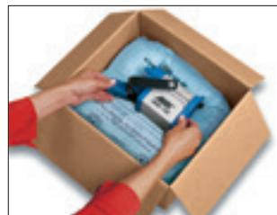
Sobald der Schaum anfängt sich auszudehnen, das zu verpackende Produkt auf den Mittelpunkt ausrichten und in Position halten, bis es vom Schaum gestützt wird.
