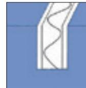
Kombiverstärkt mit 2 Längsfäden und einem Kurvenfaden
