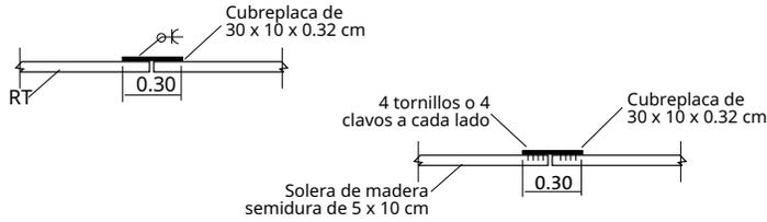
Figura 9.24 Detalle típico de la unión para garantizar continuidad de la solera
