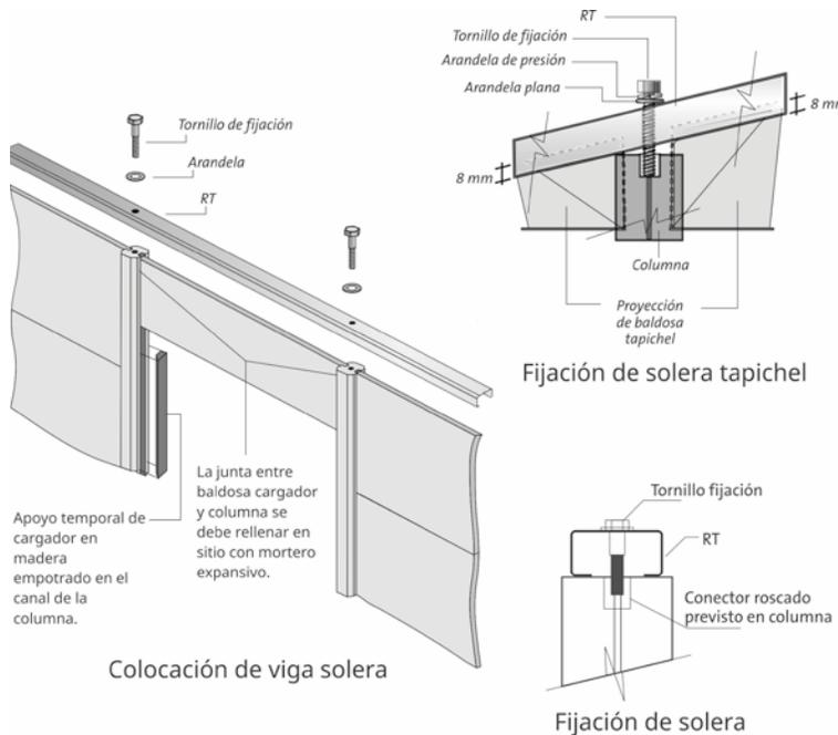
Figura 9.44 Fijación de viga solera
