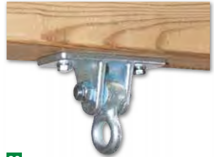
28 Schaukelhaken verzinkt, für Schaukeln, mit Messinglager und Sicherheitsmutter zur Aufhängung an der Unterseite der Querstange. Schraubenlöcher Ø 13 mm, Öse für die Befestigung von Seilen oder Ketten mit Ø 20 mm. Gesamtmaß 130 x 50 x 100 mm.
