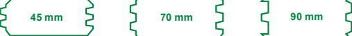
Blockbohlen 45 x 121 mm, 70 x 146 mm (mit Doppel-Nut und -Feder), 90 x 146 mm (mit Dreifach-Nut und -Feder), 4-seitig gefast
