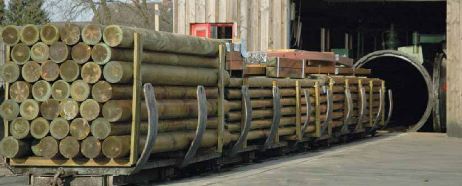
Loren mit Gartenholz – Beladen der Kesseldruckanlage
