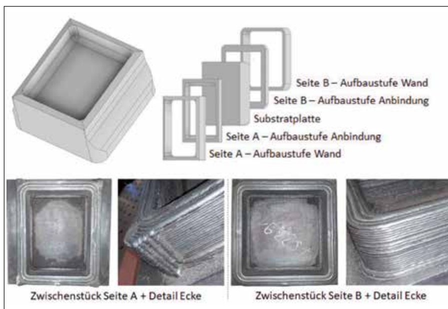
Bild 20 • CAD-Modell Zwischenstück (oben links), Zerlegung in Aufbaustufen der Seiten A und B (oben rechts) und additiv gefertigte Wandung der Seite A und B des Zwischenstücks (unten).
