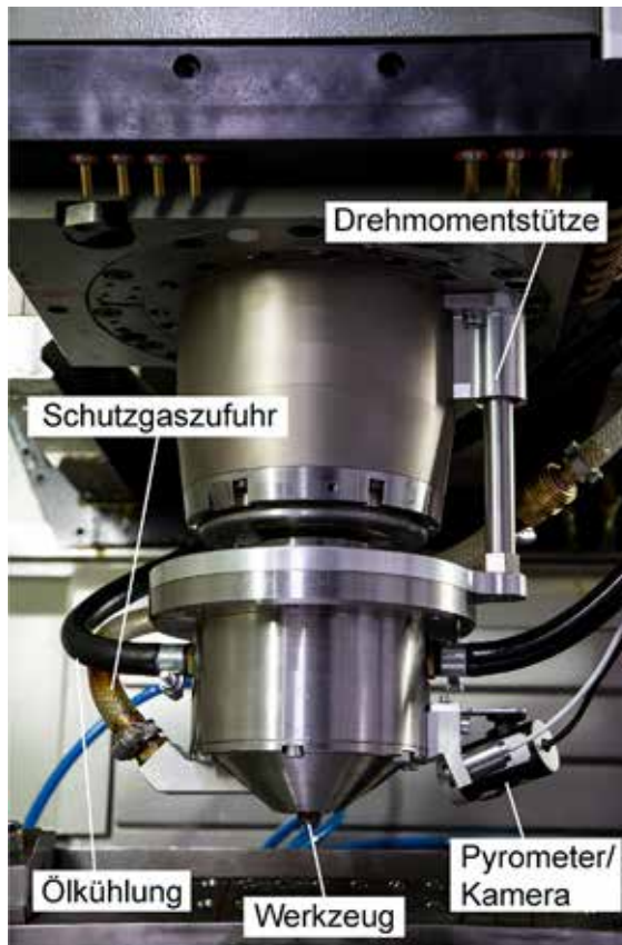
Bild 1 • Ölgekühlter Werkzeugaufnehmer mit Schutzgasumspülung.
