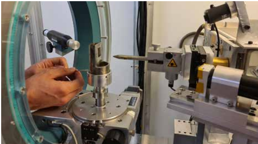
Bild 2 • Prüflabor: Positionierung einer Probe im Röntgendiffraktometer. (Bild: Paul Diekhoff, TU Braunschweig)
