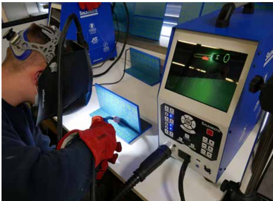
Beim digitalen Schweißen sprühen weder Funken, noch wird Werkstoff verbraucht. (Foto: HWK)
