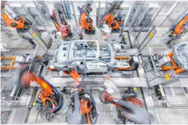
Für den Teilbereich des Unterbaus übernimmt Kuka die Integration und teilweise Taktzeitreduzierung in zwei vollautomatisierten Karosseriebaulinien. (Bild: Audi AG)
