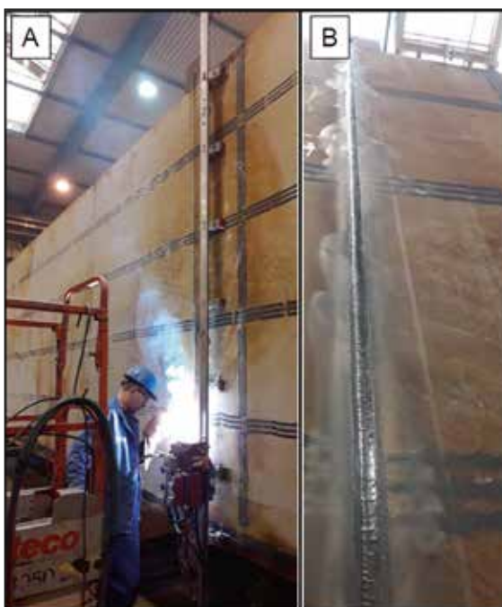
Bild 27 • Elektrogasschweißen in der schiffbaulichen Praxis der Neptun Werft (A) und EGS-Nahtoberfläche (B).
