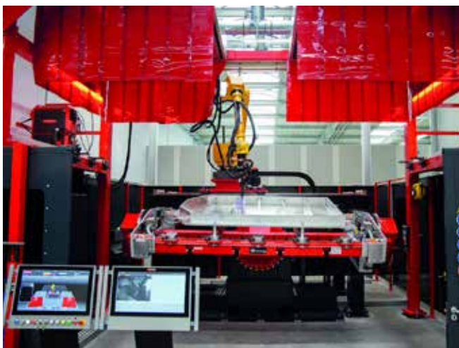
Die Roboterschweißzelle verfügt über Hightech-Prozessvarianten von Fronius, etwa Cold Metal Transfer (CMT), Pulse Multi Control (PMC) und Low Spatter Control (LSC). (Bilder: Fronius International)
