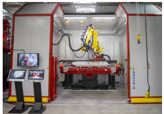
In der Laser-Hybrid-Zelle wird ein leistungsstarkes Metall-Schutzgasschweißsystem mit moderner Lasertechnologie kombiniert: Bei einer Geschwindigkeit von bis zu 8 m/min können Komponenten unterschiedlicher Werkstoffe in hoher Qualität – bei gleichzeitig geringem Verzug – verschweißt werden.
